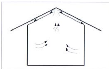
รูปที่ 2.6 หลักการทำงานของ เรือนอบพืช
