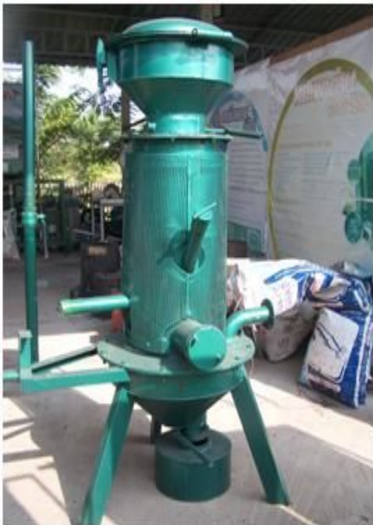
เตาแก๊สชีวมวลขนาดกลางสำหรับใช้ฟืนและถ่านไม้ เป็นเชื้อเพลิง
