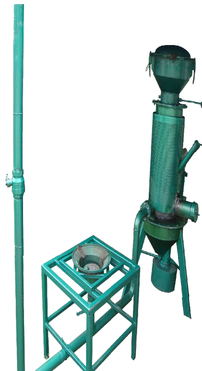
เตาแก๊สชีวมวลขนาดกลางสำหรับใช้ฟืนและถ่านไม้ เป็นเชื้อเพลิง
