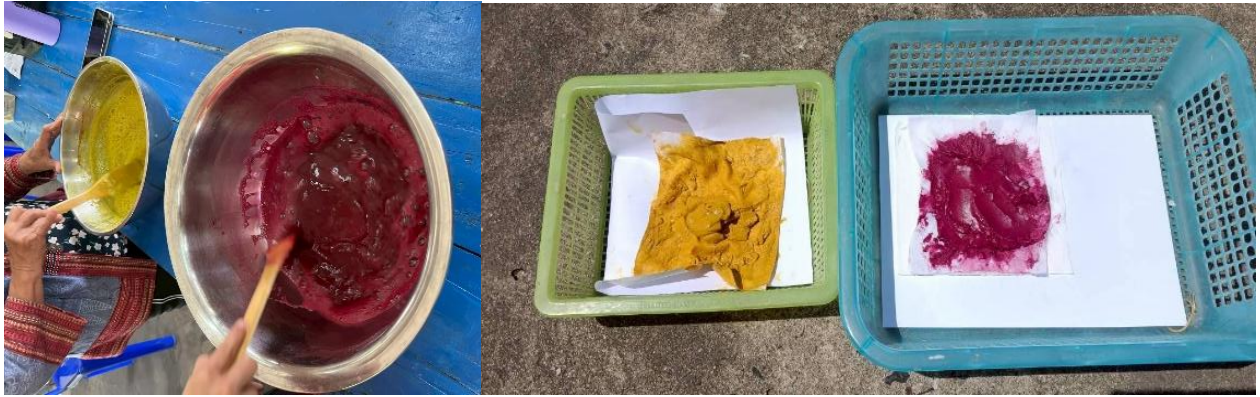
ภาพการสกัดและผลิตสีย้อมธรรมชาติจากใบสมอและแก่นฝางให้เป็นสีผงด้วยวิธีตกตะกอน
