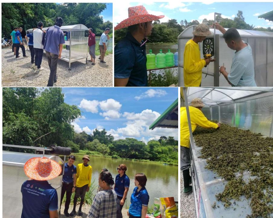
ภาพที่ 2.14 การเก็บรักษาวัตถุดิบและการเพิ่มประสิทธิภาพการตากวัตถุดิบผลิตอาหารสัตว์น้ำ ด้วยพลังงานแสงอาทิตย์
