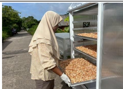
การตากด้วยตูตากพลังงานแสงอาทิตย์-โซลาร์เซลล์
