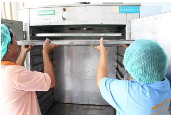
นำไปอบที่อุณหภูมิ 60 - 65 องศาเซลเซียส ประมาณ 4 - 6 ชั่วโมง
