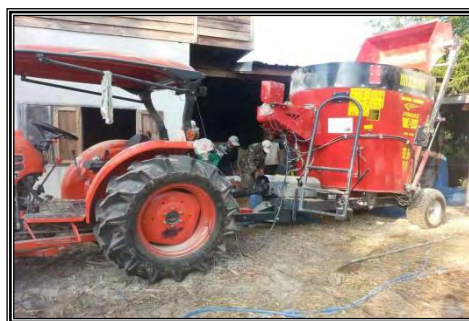
ภาพที่ 3.8 เครื่องผสมอาหาร TMR แบบเคลื่อนที่
