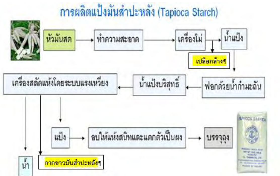
ภาพที่ 2.12 กระบวนการผลิตแป้งมันสำปะหลัง
