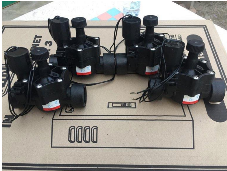
ภาพ วาล์วไฟฟ้า
