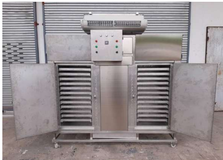
รูปที่ 8 เครื่องอบปลาช่อนแดดเดียวระบบปั๊มความร้อนประหยัดพลังงาน (Heat Pump Dyer) สำหรับ
