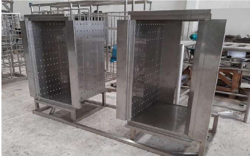
รูปที่ 6 ขั้นตอนการสร้างเครื่องอบแห้งปั๊มความร้อนสำหรับอบปลาช่อน
