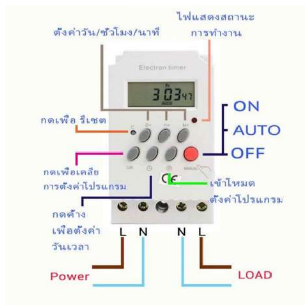
ภาพที่ 2.11 การทำงานของทามเมอร์
