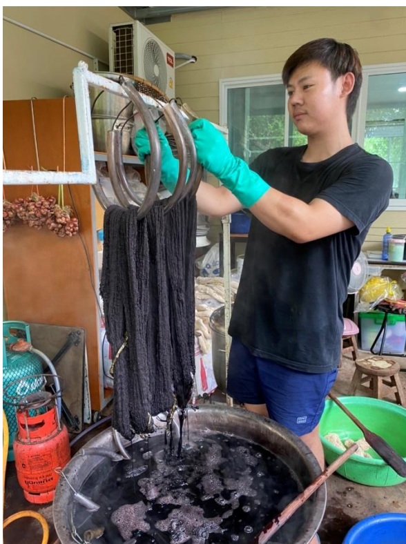
นำเส้นด้ายออกมาจากหม้อย้อม ชักให้สะอาดในน้ำเปล่า ตากในที่ร่ม อากาศถ่ายเทและมีลมพัดผ่านสะดวก
