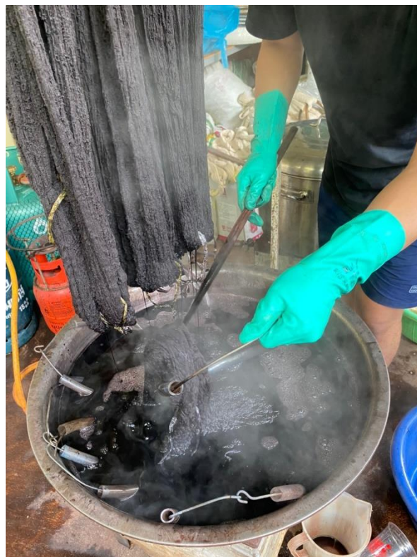
การวางเส้นด้ายในการย้อมต้องวางให้น้ำย้อมสามารถหมุนเวียนได้ดี และหมั่นพลิกเส้นด้าย เพื่อทำให้สีย้อมติดเส้นด้าย อย่างสม่ำเสมอและทั่วถึง
