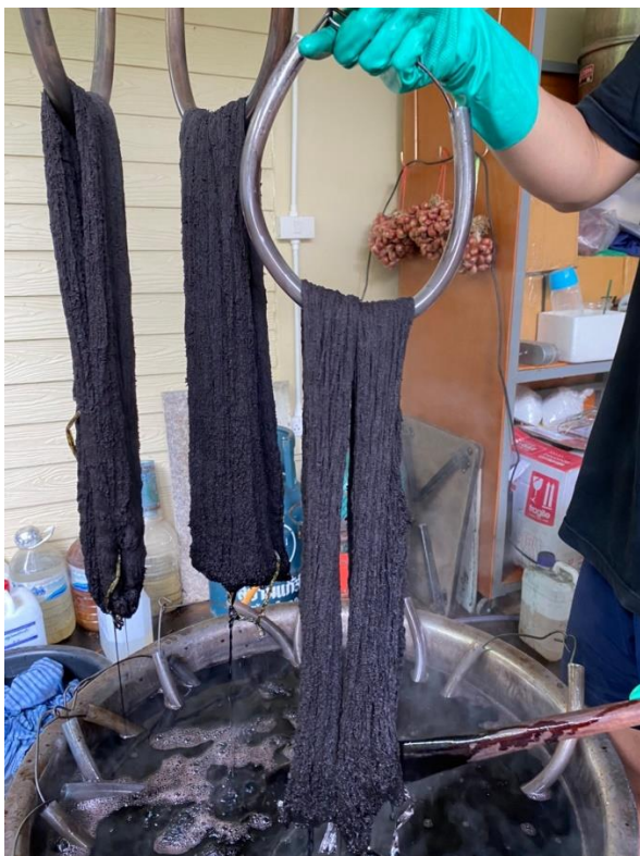
การวางเส้นด้ายในการย้อมต้องวางให้น้ำย้อมสามารถหมุนเวียนได้ดี และหมั่นพลิกเส้นด้าย เพื่อทำให้สีย้อมติดเส้นด้าย อย่างสม่ำเสมอและทั่วถึง
